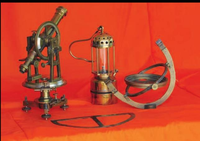
*Théodolite, lampe de Carmaux, boussole suspendue et élimètre*
