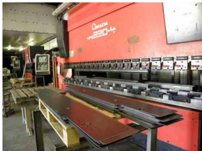
Machine de pliage à commande numérique
