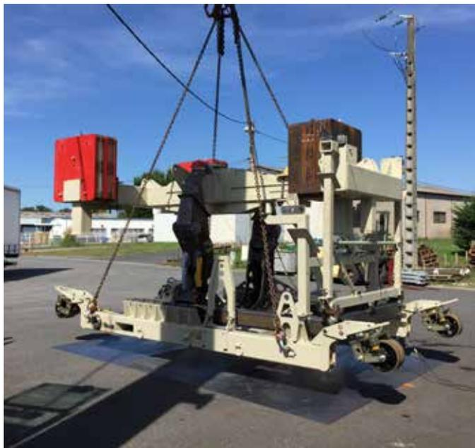
Test de lâcher sur le prototype du chariot-moteur pour le Trent XWB
